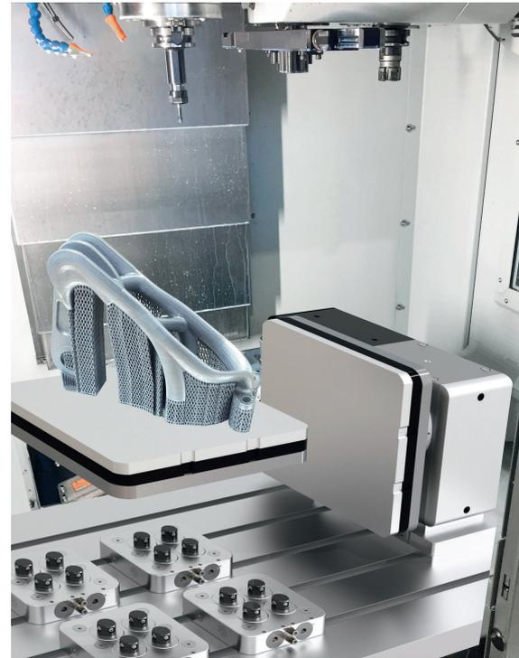
**Sicher fixiert:** Die Ball-Lock-Spannfutter erzeugen pneumatisch bis zu 40 kN Spannkraft, so dass eine hohe Zerspansleistung ermöglicht wird. © Lehmann
